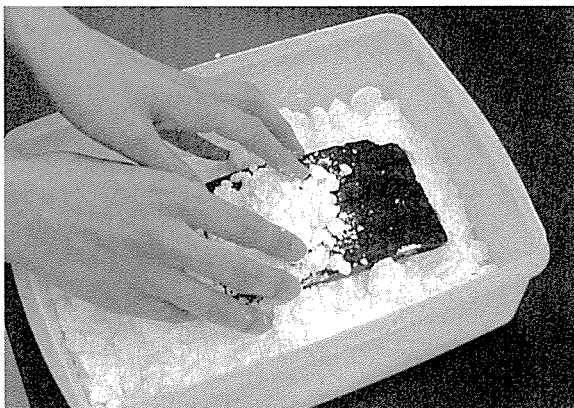
写真5 ラクチールによる木器保存処理工程（結晶化）
