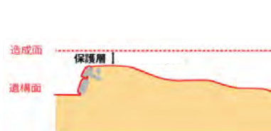
図5-6 石積み遺構 断面イメージ
