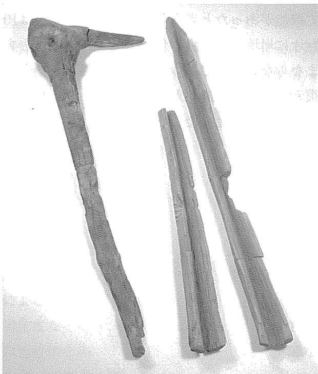
写真2 火掻き棒と送風管 (糖アルコール含浸法)
