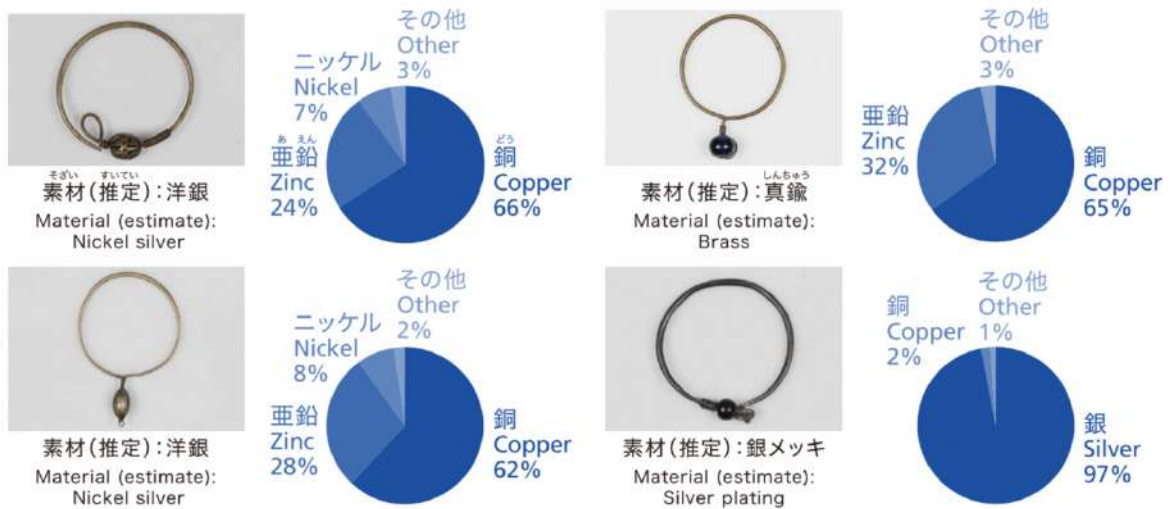
図 7. 耳飾の分析結果(寸法: 各資料約φ8mm) (円グラフ: 3 点の分析値の平均 wt%)
