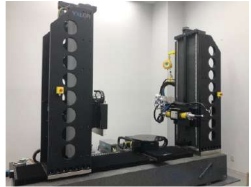
図3. 当館設置のX線CT装置
