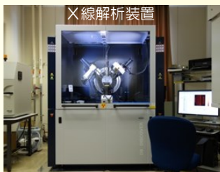
X線解析装置 資料の材質（結晶構造）を調べます
