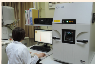
蛍光X線を使用して分析している様子
